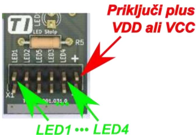
Če izhod vezja za posamezno LED diodo postavimo na »1« (3-5V), LED ne sveti, če izhod postavimo na »0« (0V), ustrezna LED dioda sveti. S PWM moduli krmilnika lahko spreminjamo moč LED diod.
